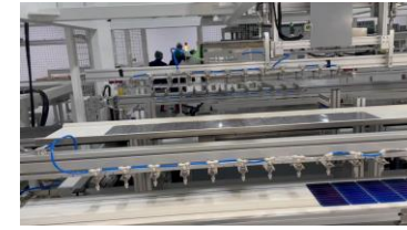
Stringer Inbuilt EL + VI Test
