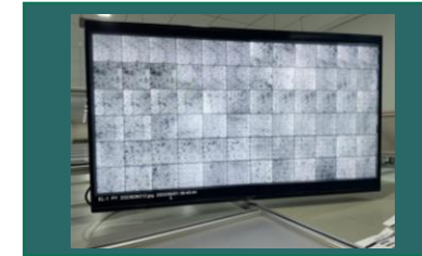
Final EL + VI Testing
